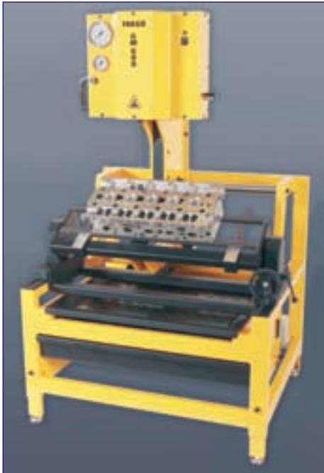
Настоящий «мастер направляющих втулок» Trego GM 600 — эксклюзивная разработка компании.
