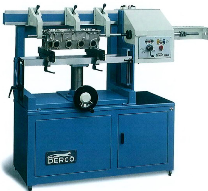
Рис. 1. Стандартная версия BT6, настроенная для расточки головки блока цилиндров.
