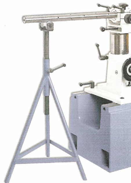
Рис. 13. Подставка для поддержки длинных борштанг.
