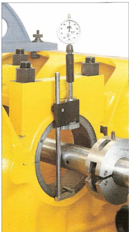
Рис. 10. Проверка диаметра коренного подшипника с установленной борштангой с помощью специального нутромера.
