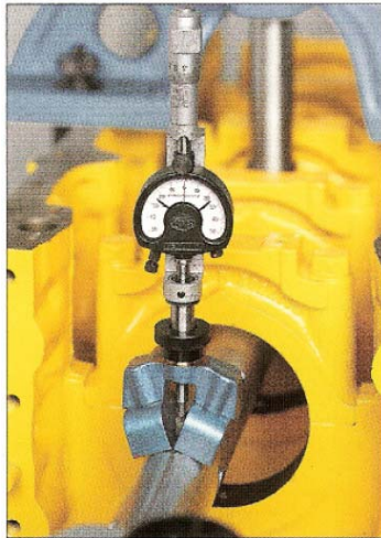
Рис. 6. Регулирование вылета резца, установленного в борштанге, с использованием измерительного прибора и V-образного суппорта.
