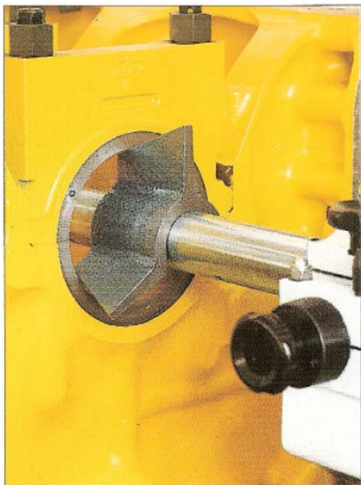
Рис. 1. Грубое центрирование борштанги в отверстии подшипника с помощью конуса.
