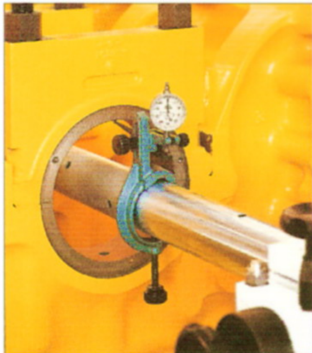
Рис. 2. Окончательное точное центрирование с центроискателем.
