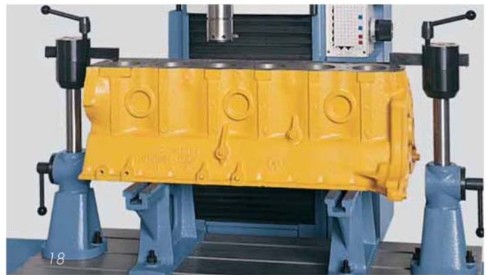
Рис. 18. Быстрое зажимное приспособление для рядного блока, установленного на параллелях.
