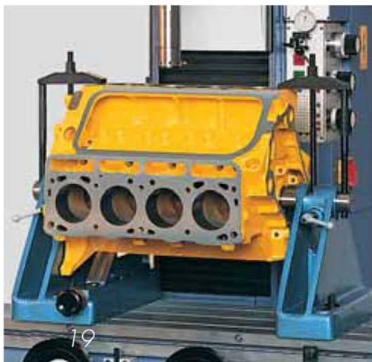
Рис. 19. Универсальная зажимная арматура PCV для V-образных блоков. Фотография показывает наклон установочной поверхности на 45°.
