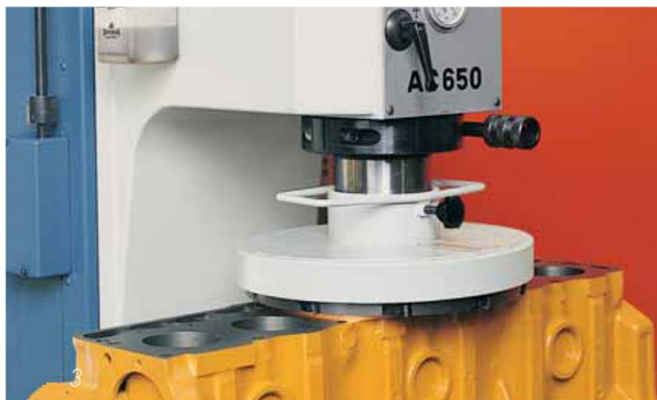
Рис. 3. Фрезерование рядного блока цилиндров фрезой с мультиугловым вставным резцом.
