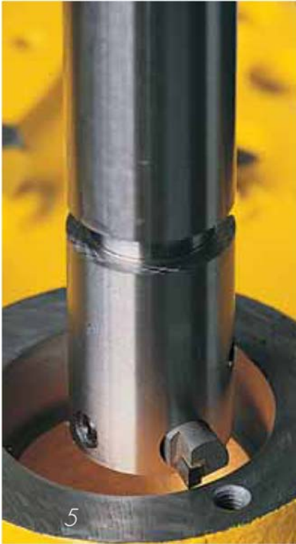
Рис. 5. Расточной узел станка с жестко закрепленным инструментом.
