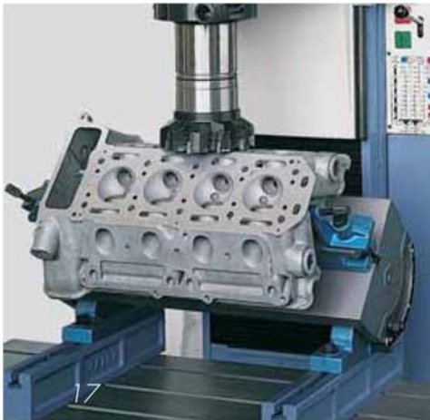
Рис. 17. Фрезерование поверхности выпускных коллекторов головки блока цилиндров, закрепленной на наклонном приспособлении. Малая фреза закреплена в универсальном адаптере.
