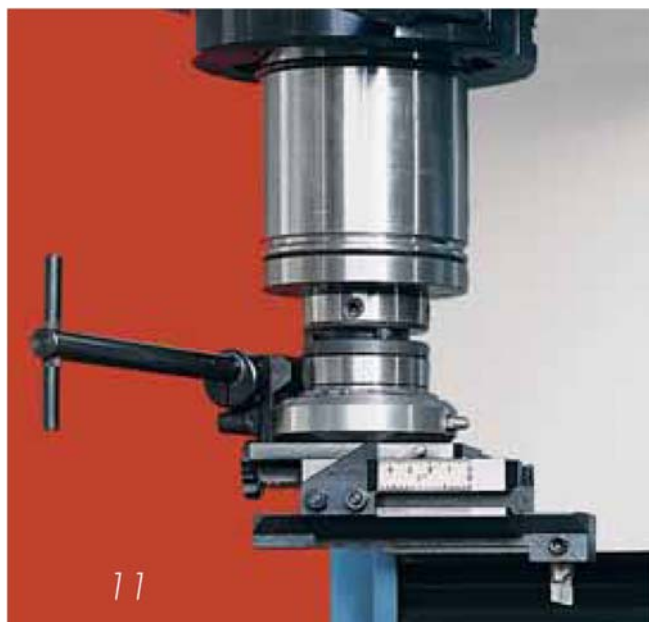
Рис. 11. Шпиндельная головка с радиальной подачей инструмента. Весьма необходимая опция для обработки фасок, торцов, фрезеровки и расточки канавок.
