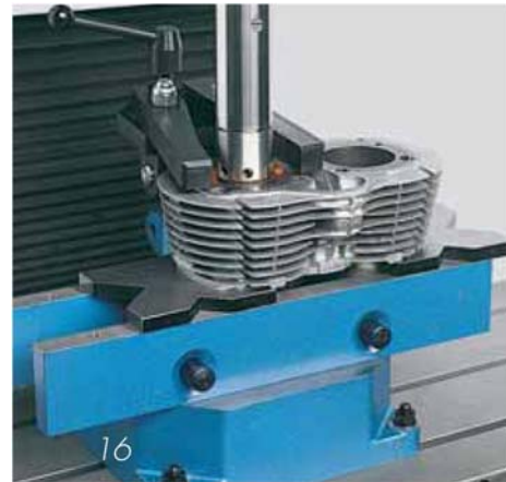
Рис. 16 - Зажимное приспособление цилиндров мотоциклов.
