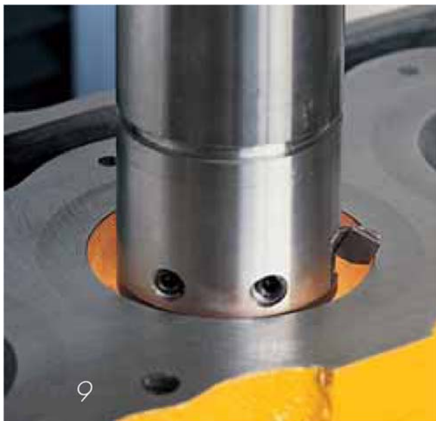
Рис. 9. Обработка фаски цилиндра фасонным резцом.
