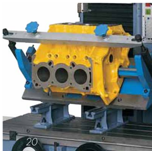
Рис. 20. Арматура для крепления V-образных блоков цилиндров с углом развала 90° и 60°.
