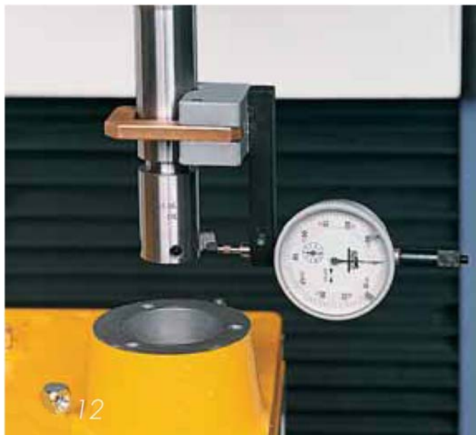
Рис. 12. Измерительный прибор DM 31 для регулировки вылета резца, закрепленный на шпинделе MA 31.
