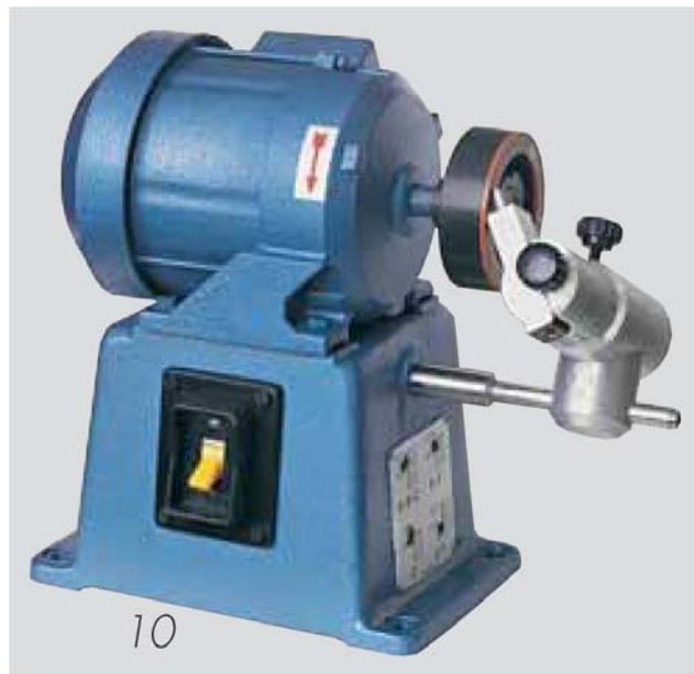
Рис. 10. Заточный станок в комплекте с алмазным шлифовальным кругом и зажимным приспособлением для резцов.
