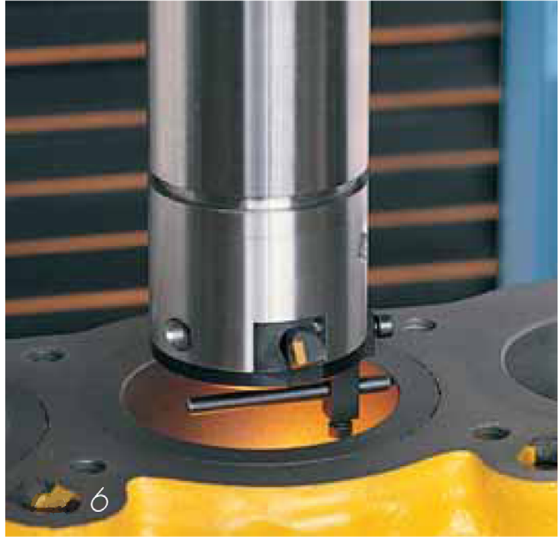
Рис. 6. Центрирование расточного шпинделя в цилиндре с помощью центроискателя.
