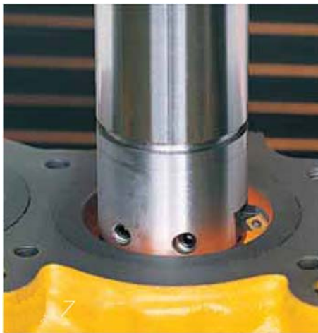
Рис. 7. Расточка цилиндра инструментом типа вставного резца.
