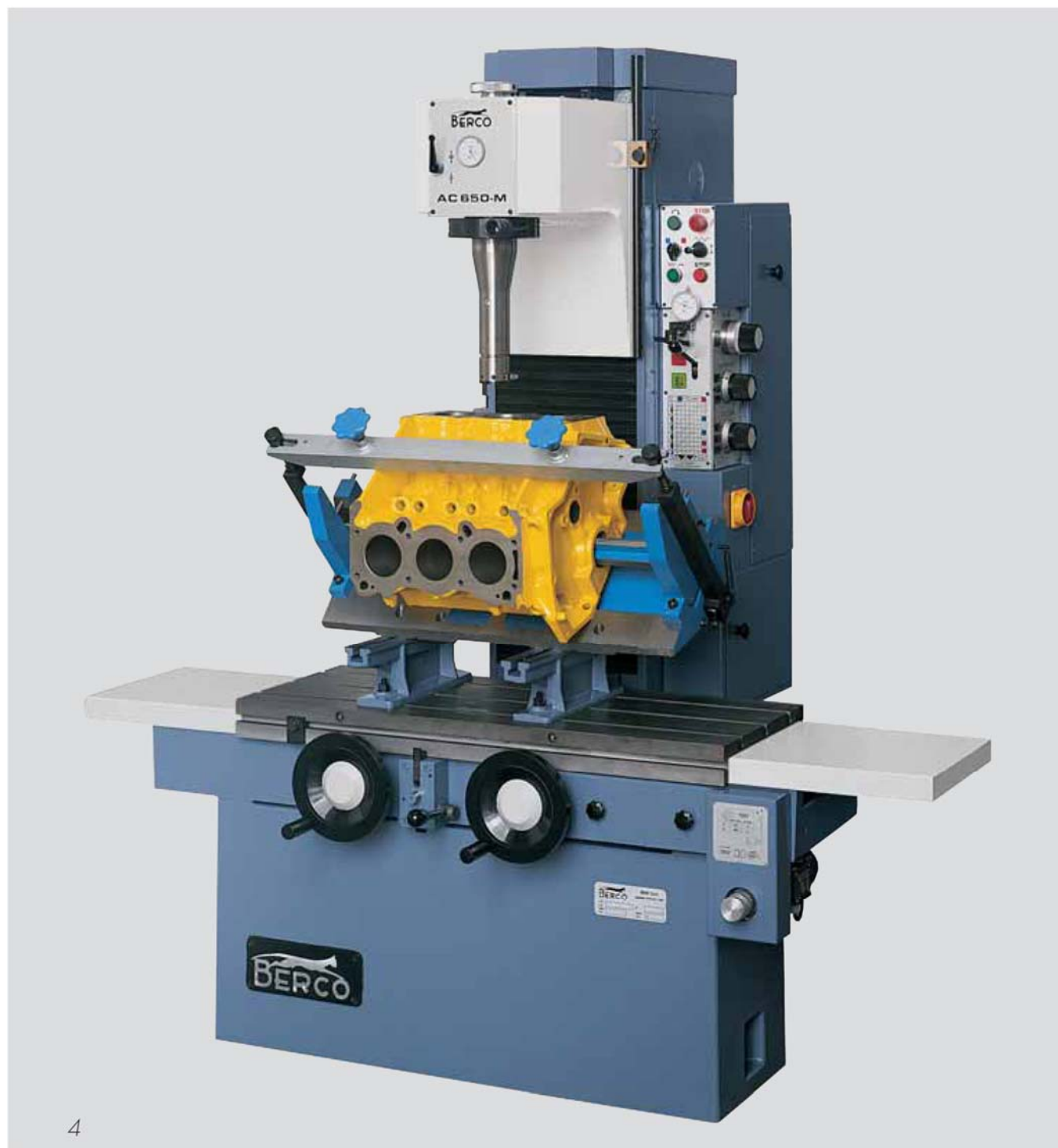
Рис. 4. Общий вид модели AC 650M с автоматическим столом, оснащенный инструментами для расточки V-образных блоков.
