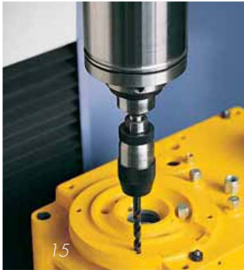
Рис. 13. Центрирование шатуна, закрепленного на арматуре PFB, для последующей расточки.
